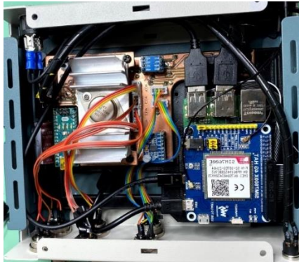
2. ábra Az elkészült útminőségmérő eszköz vezérlőegysége
